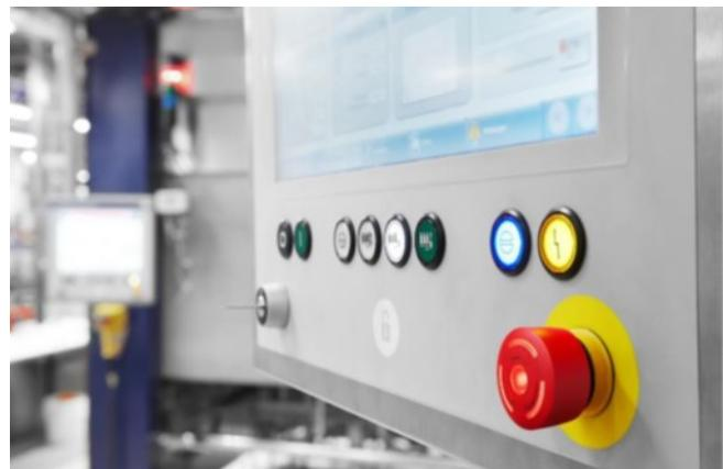
Prekidači imaju LED osvjetljenje i jasno su uočljivi u radnim prostorima s vrlo slabim osvjetljenjem.
