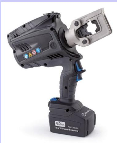
B500 je prvi alat nove generacije bežičnih alata koji rade sa akumulatorskom Li-ion baterijom od 18V i pružaju mnoge prednosti naspram starih modela. Nova baterija nudi veći kapacitet 18V/4Ah, alat ima bržu kompresiju i veću snagu krimpanja kroz 2-brzinski hidraulički sistem. Inteligentno smanjenje brzine kad uređaj počinje krimpati osigurava optimalno iskorištenje dostupne energije baterije.
