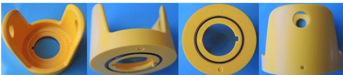
Kao alternativa dosadašnjim metalnim zaštitama od slučajnog pritiska (kat.br. 84-909) proizvedene su nove, plastične zaštite od Lexana u RAL 1003 boji (signalna žuta). Novi proizvod pruža IP65 zaštitu i može se koristiti u kombinaciji sa dodatnim osiguračem. S obzirom da konstrukcija ne može 100% garantirati slučajnu aktivaciju sa dlanom, ovaj proizvod stoga nije sukladan sa EN ISO 13850 standardom.
