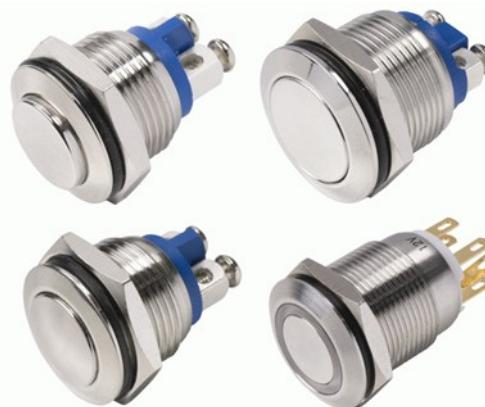
Ugradnja tipkala iz serije 82 je izuzetno jednostavna. Na donji dio tipkala se postavlja priložena brtva (standardni dio isporuke) te se tipkalo postavlja u predviđenu rupu. S donje strane panela predviđeno je fiksiranje sa maticom. Pričvršćenje instalacije na tipkalo moguće je pod vijak ili na stopicu.
